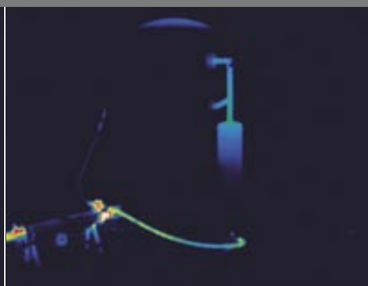
nach 5 min Schichtladung im Sphärentauscher und Erwärmung im Speicher oben
